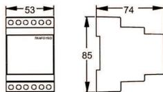
Traf040/D 230 VAC / 12 und 24 VAC, 40 VA, IP 44 für Hutschiene mit thermischer Überlastsicherung
