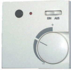
RF-PT1000-P1-S-T-Lr Raumfühler PT 1000 Hauptschalter EIN / AUS Poti 1 kOhm Taster LED rot
