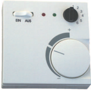
RF-PT1000-P-S-D6-Lgr Raumfühler PT 1000 Hauptschalter EIN / AUS Poti 50 Ohm Drehschalter 1 - 6 LED rot, LED grün
