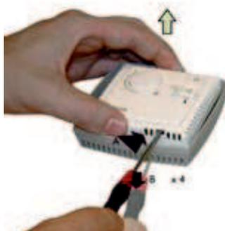
2. Regler vorsichtig an den 4 Aussparungen aus der Bodenplatte hebeln
