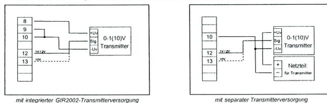
**Anschluß eines 0-1/2/10V bzw. 0-50mV Meßumformers in 4-Leiter-Technik**
