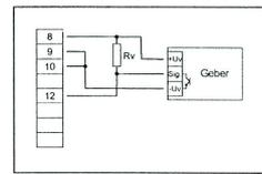
Anschluß eines Gebers (mit GIR2002-Versorgung) mit NPN-Ausgang mit erforderlichem externen Widerstand
