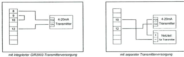
**Anschluß eines 0(4)-20mA Meßumformers in 3-Leiter-Technik**
