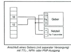
Anschluß eines Gebers (mit separater Versorgung) mit TTL-, NPN- oder PNP-Ausgang
