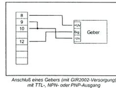
Anschluß eines Gebers (mit GIR2002-Versorgung) mit TTL-, NPN- oder PNP-Ausgang
