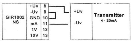
**Anschluß eines 0(4) - 20mA, 0-1V, 0-10V Transmitters in 3-Leitertechnik**
