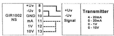
**Anschluß eines 0(4) - 20mA, 0-1V, 0-10V Transmitters in 4-Leitertechnik**
