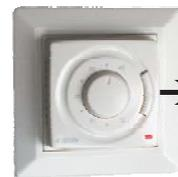
Zum Öffnen Knopf auf 20 °C stellen. Anschließend Befestigungshaken an der rechten Seite vorsichtig nach innen drücken und gleichzeitig den Deckel nach vorne ziehen. Nun den Abdeckrahmen entfernen.
