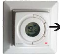
Zum Öffnen Befestigungshaken an der rechten Seite vorsichtig nach innen drücken und gleichzeitig den Deckel nach vorne ziehen. Nun den Abdeckrahmen entfernen.
